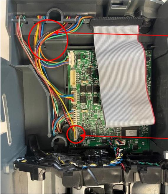
Veiller à positionner les fils des cordons autour de l'ergot plastique afin de permettre la remise en place du capot de protection
