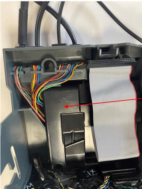
Remettre en place le capot en veillant à ce que les fils ne gênent pas sa mise en place
